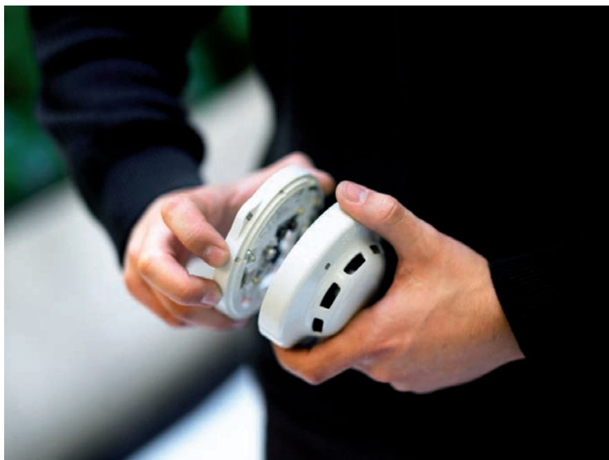
Bild 3: Rauchmelder sind im Server- und im Technikraum in den Decken, den Zwischenböden und den geschlossenen Elektroschränken installiert.
